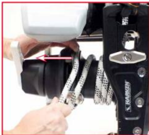
将绳索嵌入绳索抓斗器中。提起保护盖，使本步骤更容易操作。
