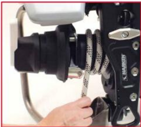
将绳索按顺时针方向缠绕在摇柄筒上。
