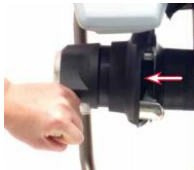
通过旋转及释放操作杆，来检查绳索抓斗器的工作情况(打开 JAW)
