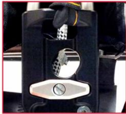
确保绳索已经正确被安装在把手里面。
